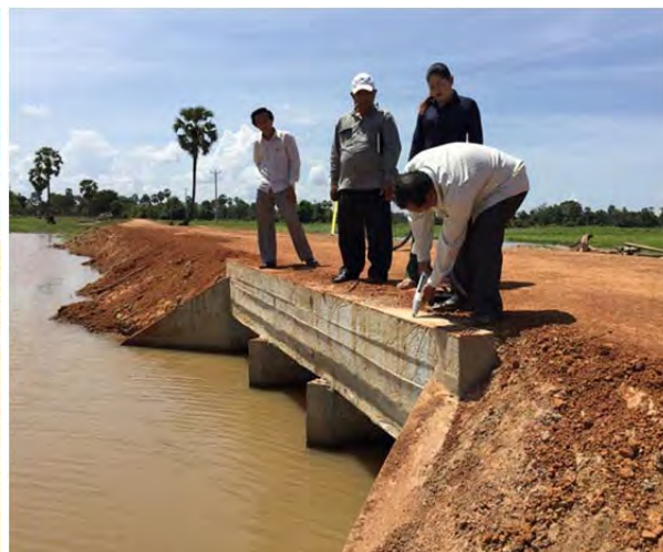
ការត្រួតពិនិត្យគុណភាពបេតុងលូជ្រុងមុខបី របស់មន្ត្រីបច្ចេកទេសហេដ្ឋារចនាសម្ព័ន្ធ លើគម្រោងមូលនិធិឃុំ ពង្រក្រោម ស្រុកជីក្រែង ឆ្នាំ២០១៧ ដោយប្រើឧបករណ៍ Concrete Hammer (ពិនិត្យភាពរឹងមាំរបស់បេតុង)
