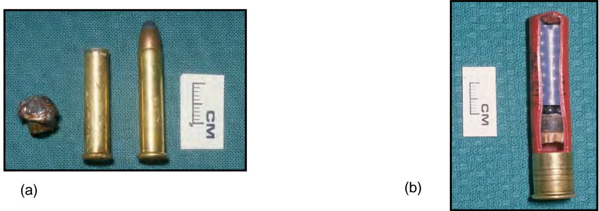
(a) សំបកគ្រាប់កាំភ្លើងគ្រាប់ទោល (b) សំបកគ្រាប់កាំភ្លើងគ្រាប់ប្រាយ ផ្ទុកទៅដោយរំសេវនៅខាងក្នុង។ គ្រាប់តូច និងស្រទាប់ ស្រោបគ្រាប់ ក្នុងគ្រាប់ដែលគេចោះបើកមើល។
